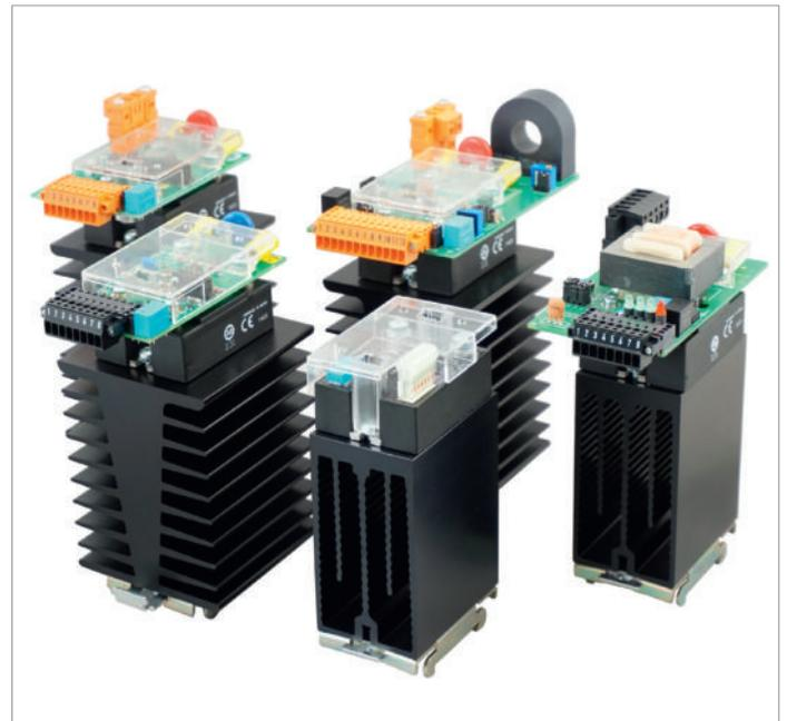
Die Ansteuerung kann in allen Betriebsmodi analog, mittels 0 - 10 V Steuerspannung, digital als serielles Telegramm bzw. als Bus erfolgen. Selbstverständlich verfügen die LEBER Leistungssteller über eine ganze Reihe von Überwachungsfunktionen wie Sicherheitsfall, Drahtbruch, Unterspannungserkennung etc. und es können weitere Sonderfunktionen z.B. Strombegrenzung, Teillastausfallerkennung via Software implementiert werden.
