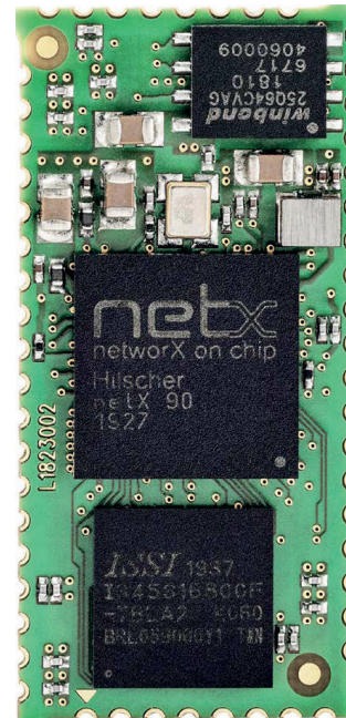
Das lötbare Kommunikationsmodul ,netRapid 90' von Hilscher
